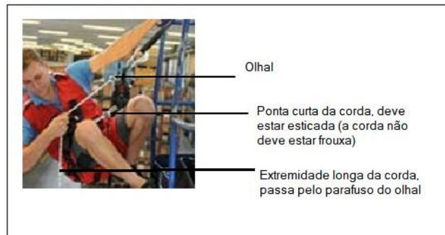
Usando os olhais de reenvio, você pode controlar a velocidade de descida ou parar a descida. A extremidade da corda mais longa e descarregada atravessa os olhais de reenvio. Se você segurar a extremidade da corda mais longa, poderá acelerar a velocidade de descida ou parar a descida. Se você não usar os parafusos oculares, a velocidade de descida será regulada automaticamente pelos freios de volante (velocidade aprox. 0.8m/segundos).
