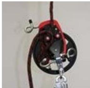
Você pode bloquear o dispositivo depois de parar correndo a corda para fora do dispositivo fazendo um giro em U para o parafuso do olhal e de volta através do grampo da corda, como mostrado (pegue o volante enquanto faz isso).
